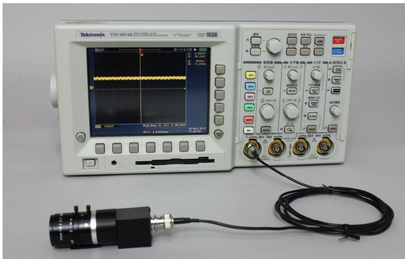
測定例1 室内光の場合 絞りを開放にした状態 約200mV出力
